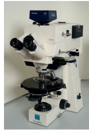
Abb. 2: Durchlichtmikroskop zur Analyse von Holzproben.
