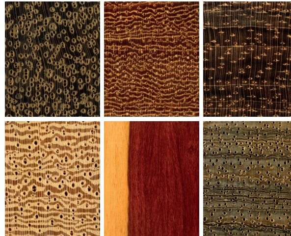
Abb. 7: Lupenfotos der Querschnitte von Sucupira ( Bowdichia nitida ), Pau Rosa ( Swartzia spec. ), Bubinga ( Guiburtia spec. ), Lati ( Amphimas pterocarpoides ), Zebrawood ( Microberlinia spec. ) sowie dem Längsschnitt von Padouk ( Pterocarpus spec. ).
